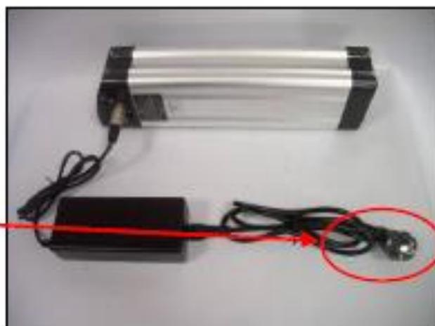
Connecter le chargeur et la source de tension.
