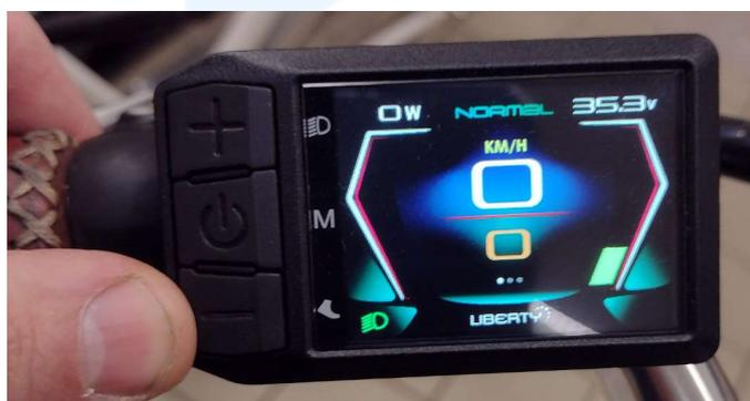
Enfin, le display commande aussi l'éclairage avant (l'arrière s'allume directement de la batterie).
