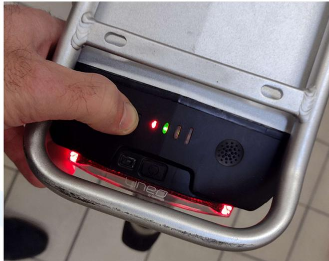
Un porte fusible permet de protéger la batterie en cas de chocs ou de sur tension. Il se trouve à cet endroit (NB. Un fusible de rechange est livré avec la batterie).
