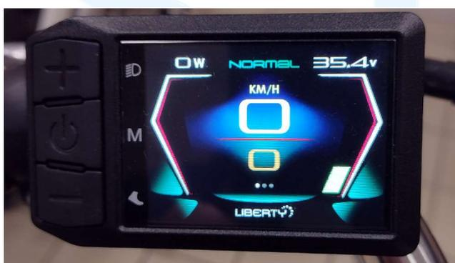
Cet écran permet de voir le niveau d'assistance (de 0 à 5), la puissance en Watt et celle en volt.
