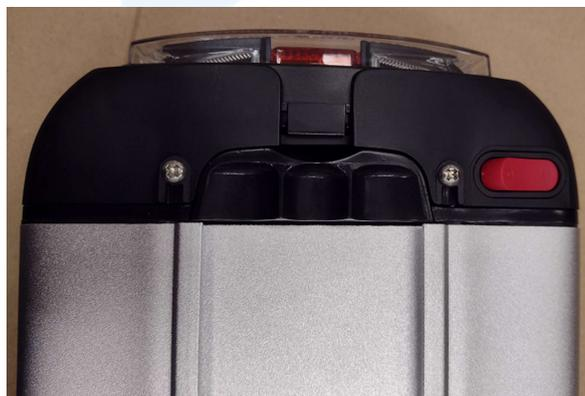
La batterie est également équipée d'un témoin de charge (4 diodes) en appuyant sur ce bouton
